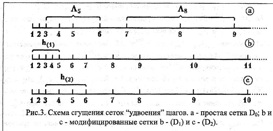
Рис.3. Схема сгущения сеток “удвоения” шагов. а - простая сетка  $D_0$ ; б и с - модифицированные сетки б - ( $D_1$ ) и с - ( $D_2$ ).
