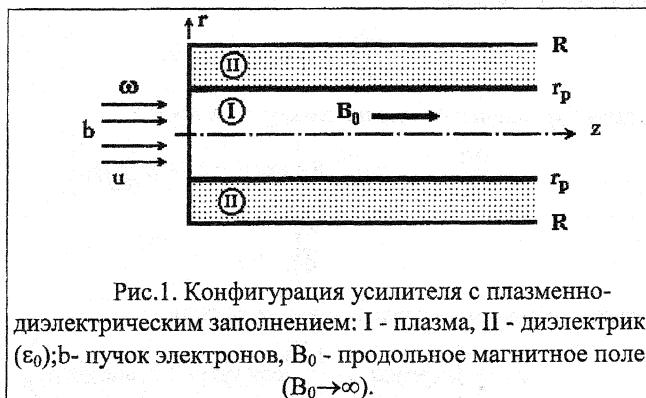
Рис.1. Конфигурация усилителя с плазменно-диэлектрическим заполнением: I - плазма, II - диэлектрик ( $\epsilon_0$ );  $b$  - пучок электронов,  $B_0$  - продольное магнитное поле ( $B_0 \rightarrow \infty$ ).
