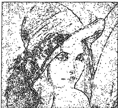
Рис.12. Результаты выделения границ для зашумленного ( ns=20 .) изображения "Лена" с пороговым критерием D_2 \wedge D_4 и пороговыми T_1 = 6 , T_2 = 2 , N=256 , методом Эрмита (левый рисунок) и с использованием ряда Фурье (правый рисунок).
